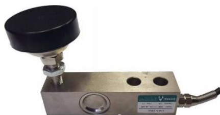
Рисунок 7 – Тензометрический датчик балочного типа
